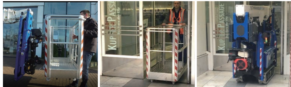
バスケットは容易に着脱できます。バスケットを外すとシングルドアの通過が可能です
