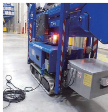
標準のハイブリッド仕様の他にオプションとしてバッテリーのみ仕様とエンジンのみ仕様があります
