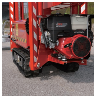
標準のハイブリッド仕様の他にオプションとしてバッテリーのみ仕様とエンジンのみ仕様があります
