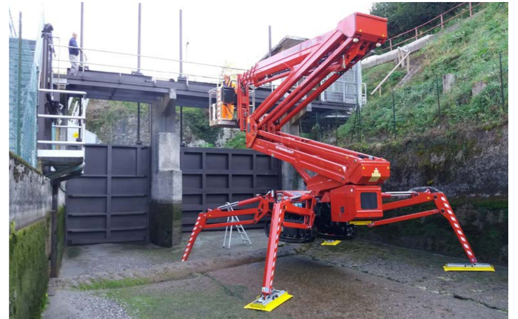
車両型の橋梁点検車ではアプローチできない場所に設置できます
