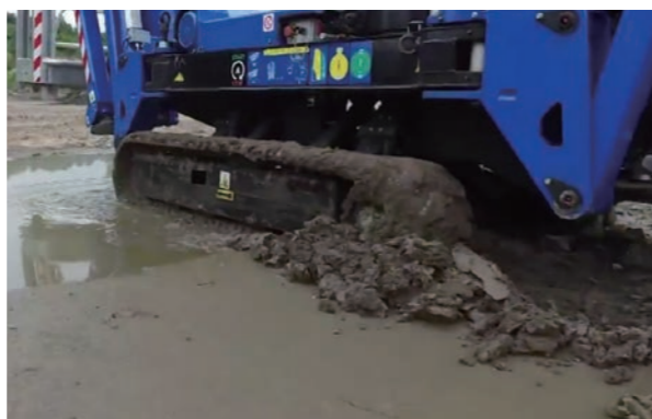
クローラーはホイールと比較し、設置面積(荷重分布)が大きいため床面に優しく、また段差や不整地の走破性に優れています
