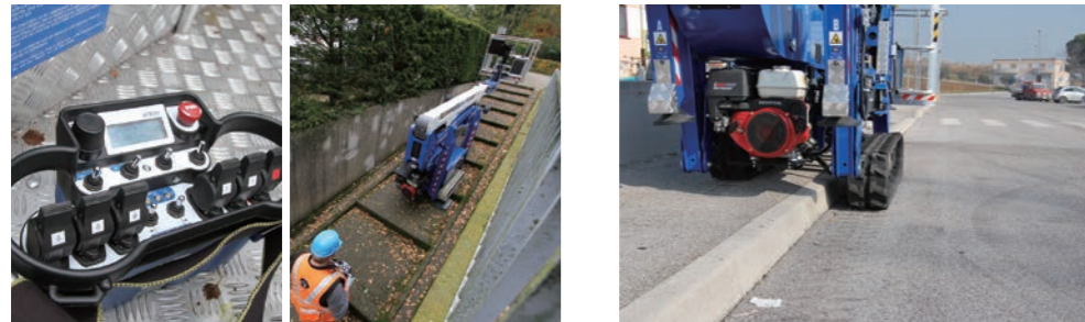
操作ボックスをバスケットから外してリモートコントロールで自走させます
